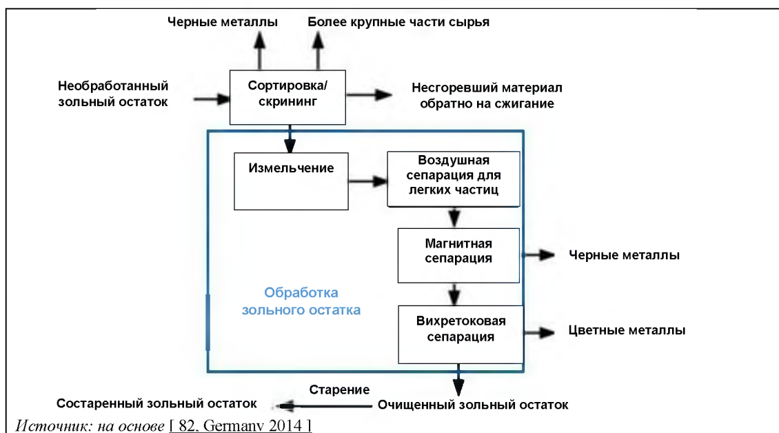
Рисунок 4.11: Схема примера процесса обработки зольного остатка с некоторыми этапами механического разделения, используемыми для очистки зольного остатка
