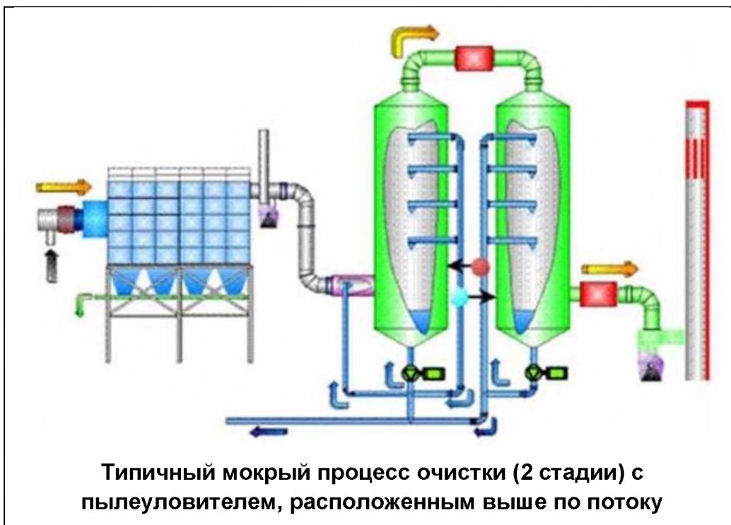
Рисунок 2.36: Схема двухступенчатого мокрого скруббера с удалением пыли вверх по потоку
