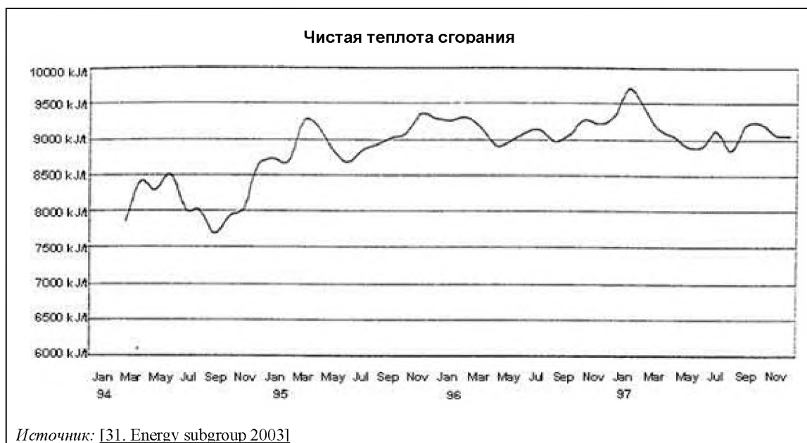
Рисунок 2.28: График, показывающий зарегистрированные изменения НТС отходов на установках сжигания ТКО за 4 года (кДж/т)
