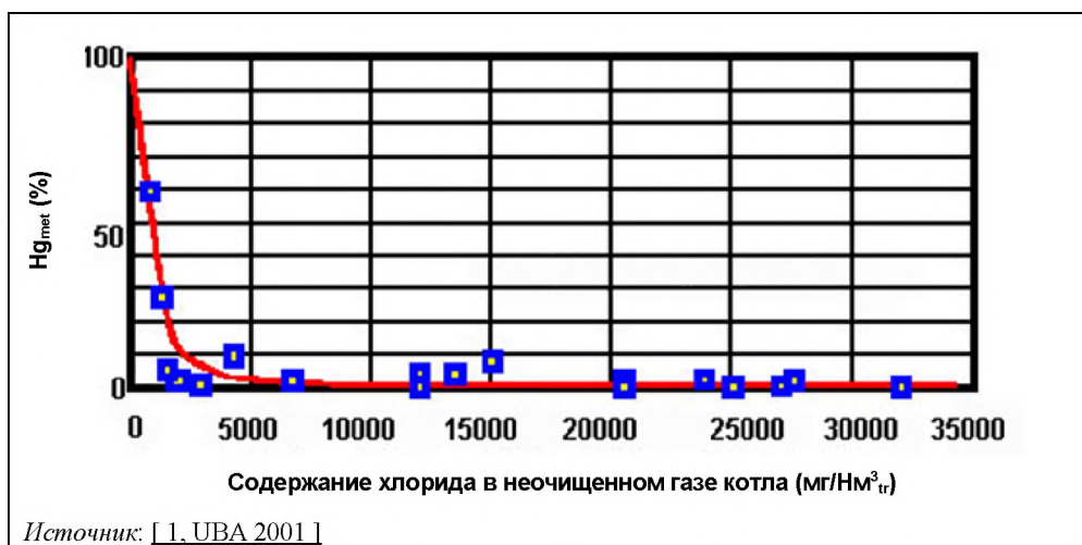
Рисунок 2.43: Взаимосвязь между долей ртути, присутствующей в элементарной форме, и содержанием хлоридов в неочищенном газе на установке сжигания опасных отходов
