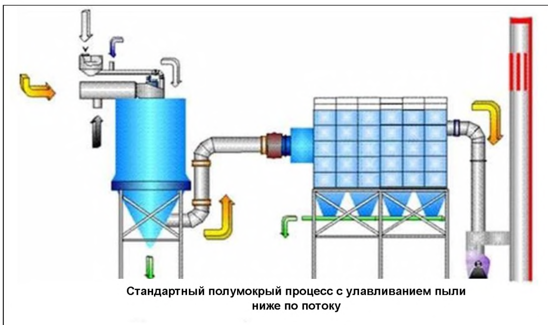
Рисунок 4.6: Типичная конструкция полумокрой системы ОДГ
