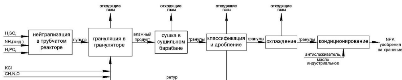
Рисунок 13.3 – Блок-схема производства комплексных NPK-удобрений
