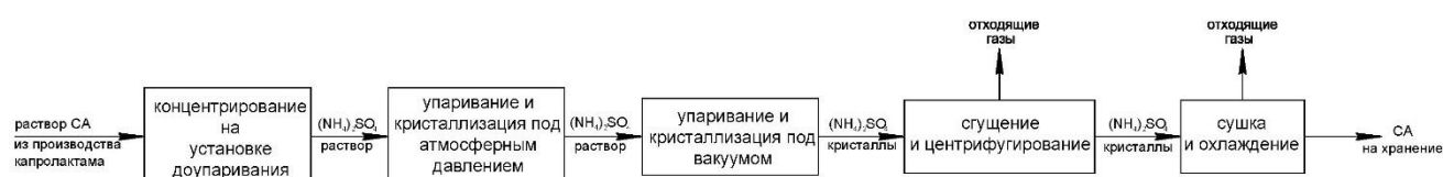
Рисунок 11.1 – Блок-схема производства СА из сульфатных щелоков
