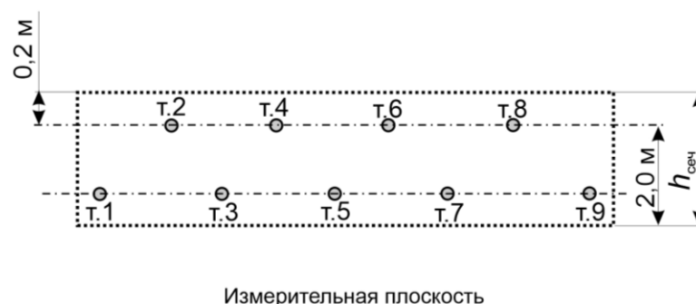
Рисунок В.2 – Схема расположения измерительной плоскости и точек отбора проб
