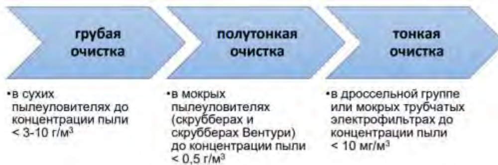
Рисунок 5.15 – Многоступенчатая система очистки доменного газа
