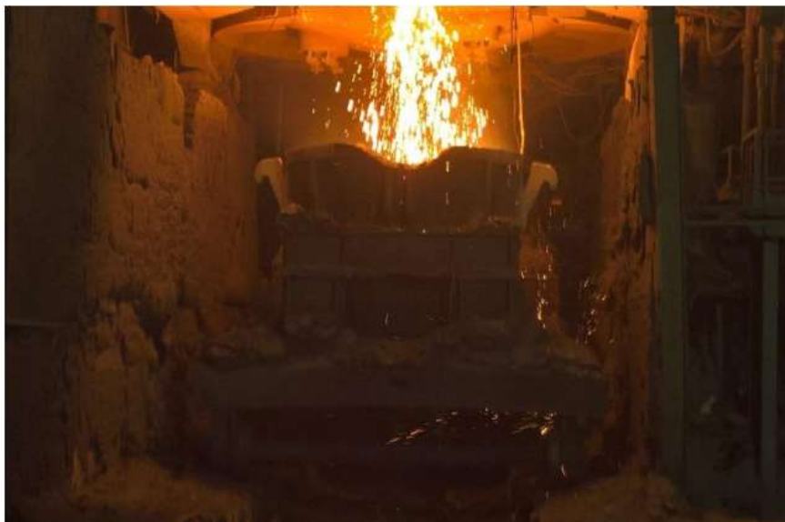
Рисунок 6.22 – Слив шлака под печь в шлаковую чашу
