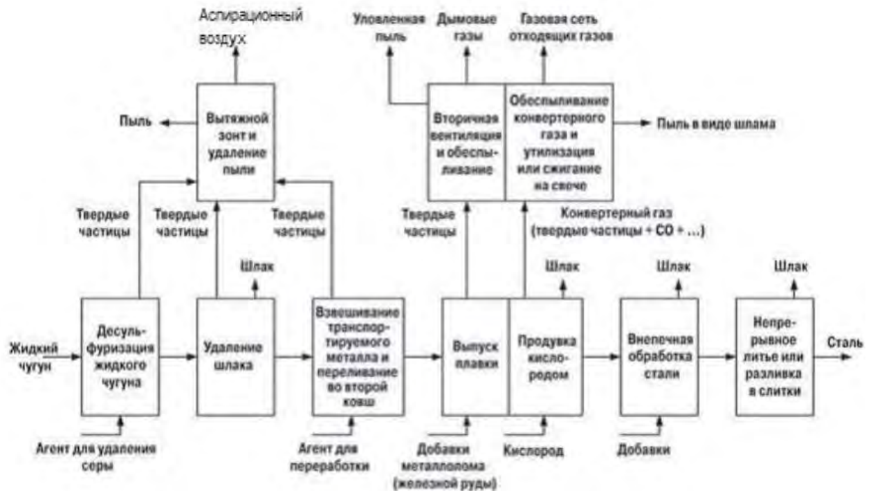
Рисунок 6.5 – Блок-схема процесса конвертерного производства стали с указанием источников выбросов [17]
