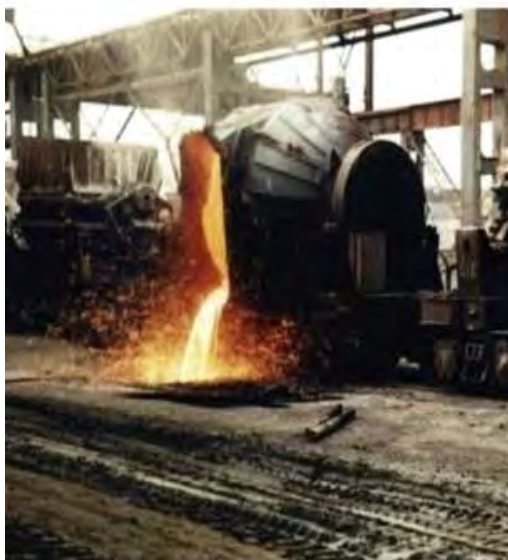
Рисунок 8.7 – Шлаковоз-миксер вместимостью 36 м 3 .
