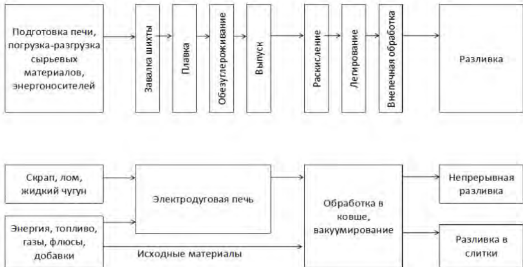
Рисунок 6.13 – Технологический процесс производства стали в ДСП, заготовок и слитков
