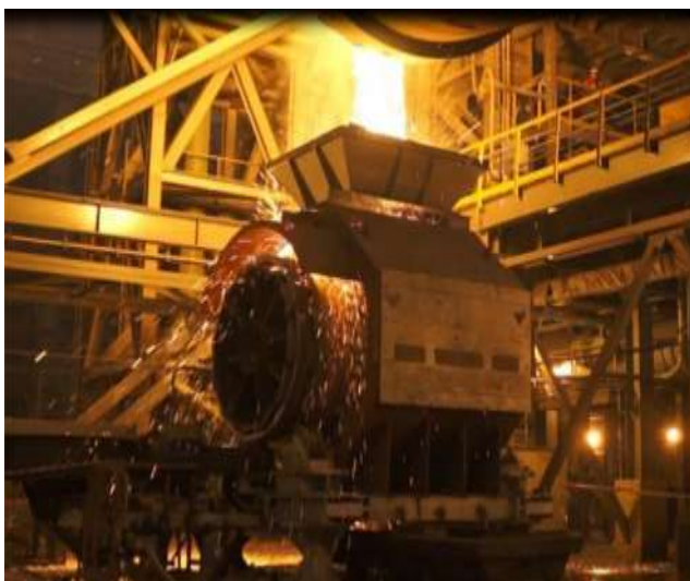
Рисунок 8.11 – Барабанный кристаллизатор для интенсивного охлаждения шлака [76]
