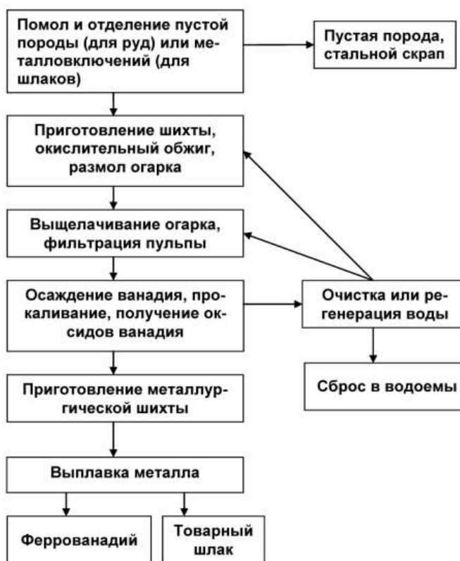
Рисунок 7.19 – Принципиальная схема производства оксидов ванадия и феррованадия
