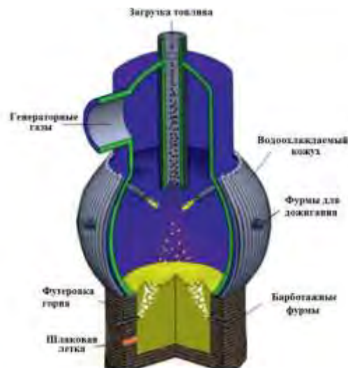
Рисунок 8.6 – Политопливный газогенератор конструкции НИТУ «МИСиС» [180]
