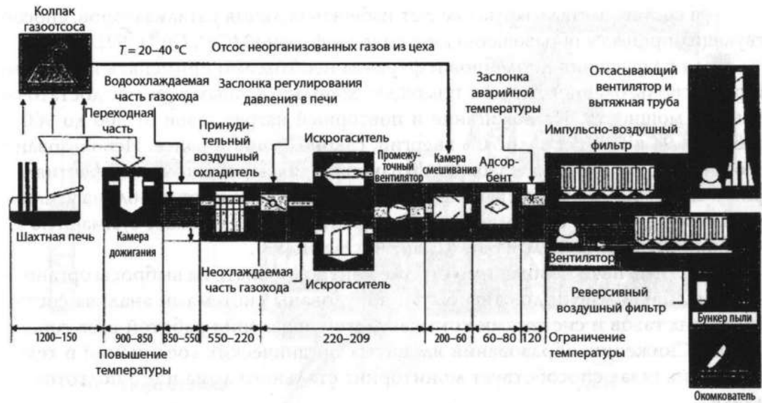
Рисунок 6.24 – Современная технологическая схема системы газоочистки шахтной дуговой печи
