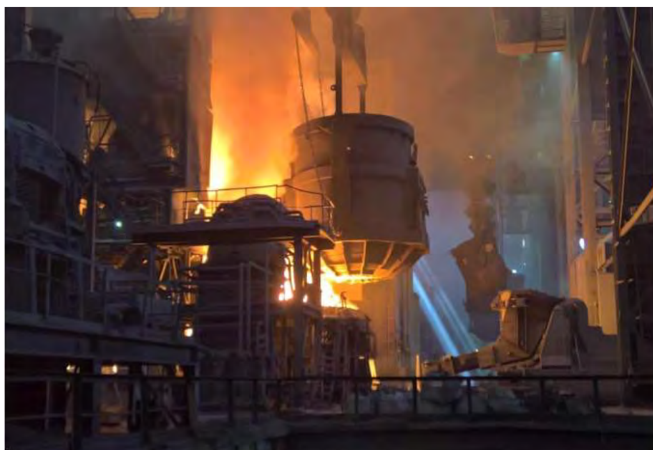
Рисунок 6.19 – Завалка шихты бадьей в ДСП-180, рядом на манипуляторе находится желоб для заливки чугуна, на кране висит ковш с чугуном
