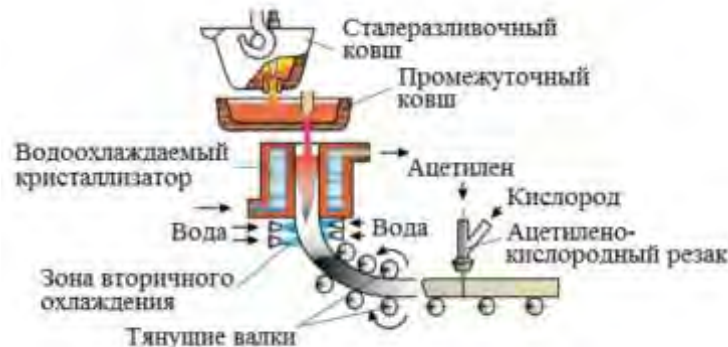
Рисунок 6.3 – Устройство МНЛЗ криволинейного типа
