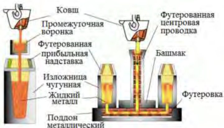
Рисунок 6.4 – Разливка стали в изложницы (слитки)
